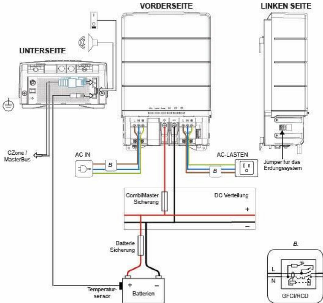
Abbildung 3: Installationszeichnung CombiMaster
