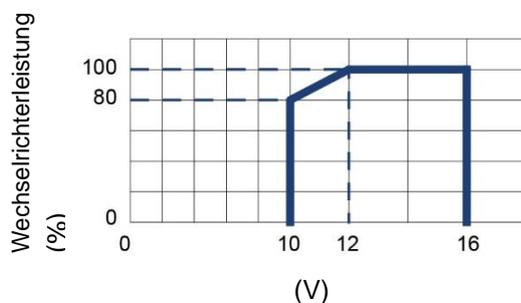
(Multiplizieren Sie bei einem 24-V-Batterieladegerät die Spannungen mit zwei)
