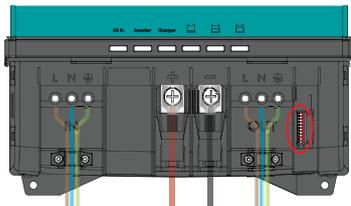
**Anmerkung:** Wenn sie zu einem CZone-Netzwerk hinzugefügt werden, dienen die DIP-Schalter der Einstellung der CZone-Adresse.
