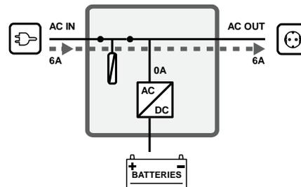
Hier erreicht die AC-Belastung den AC IN-Grenzwert (6 A). Das bedeutet, dass keine Leistung zum Laden der Batterie übrig ist. Zu diesem Zeitpunkt reduziert der CombiMaster seinen Ladestrom auf 0 A.
