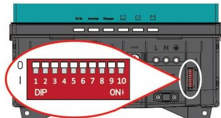
DIP-Schalter 1 = CZone-Netzwerk (0↑) oder MasterBus-Netzwerk (1).
